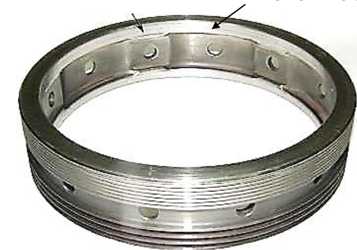
Ремонт лабиринтов наплавкой
