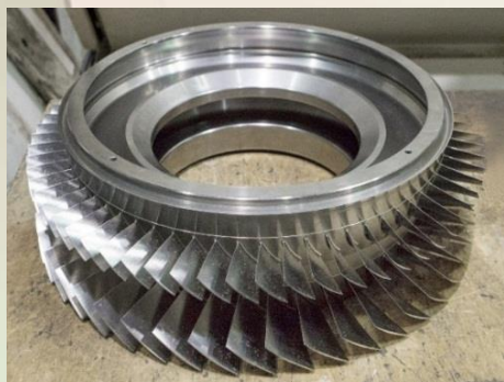
Секция ротора 1-2 ст. КВД из ВТ41
