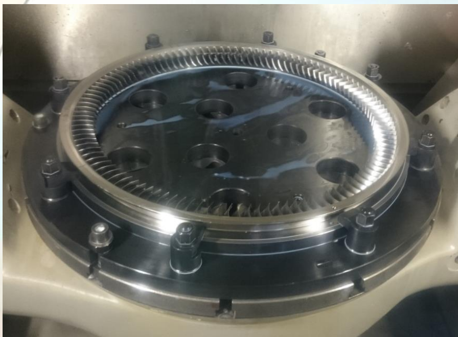
Аппарат направляющий 3 ст. КВД – «блинг»
