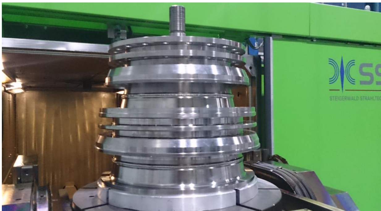
Барабан 1-2 ступени (в оснастке для сварки)
