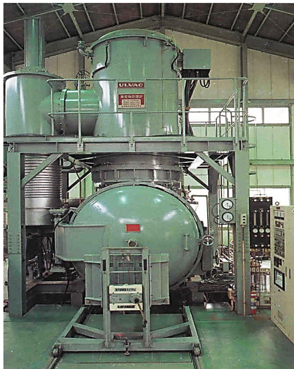
Печь ULVAC с рабочим пространством \varnothing 900 \times 900 мм, точность по температуре \pm 5^\circ\text{C}
