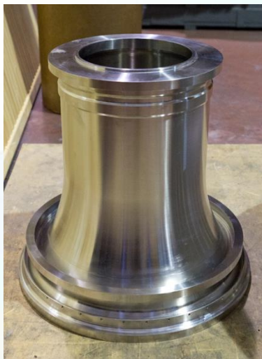
Внешний вид вала КВД из сплава ВЖ172-ИШ
