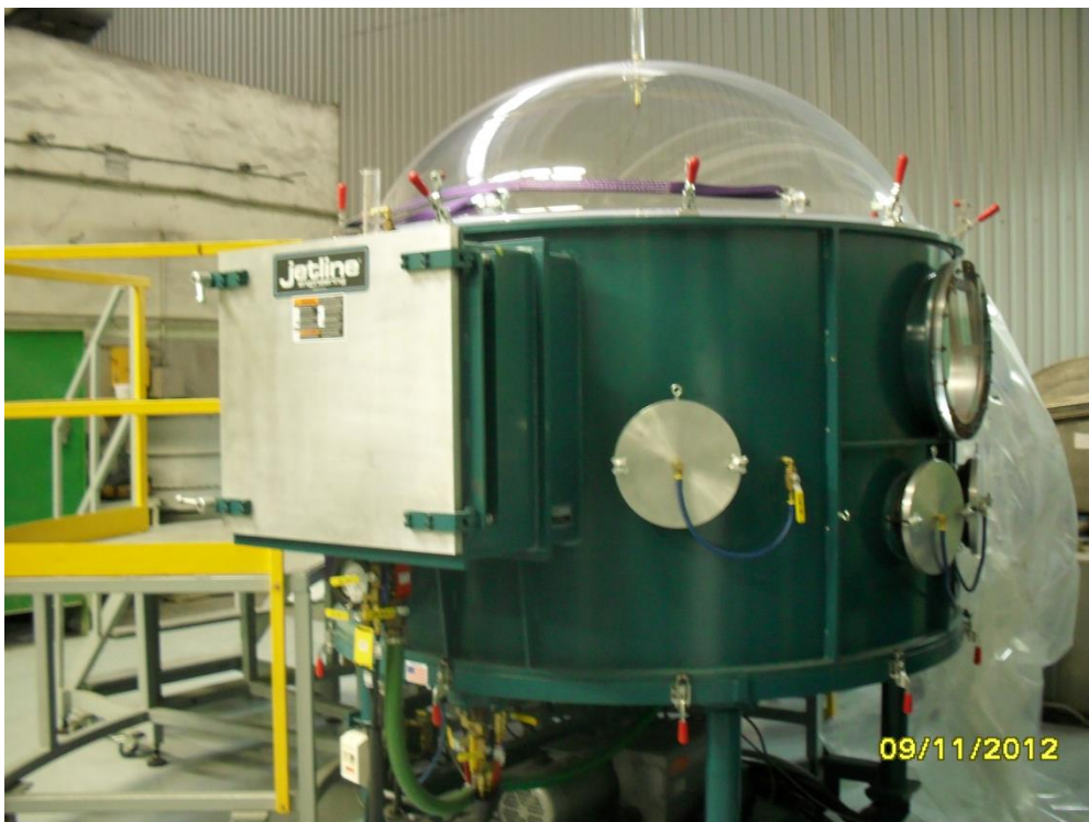
Сварочная камера с контролируемой атмосферой VC-72Z
