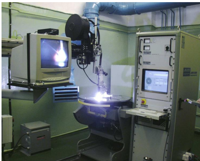
Установка Dabber RBM фирмы Liburdi (Канада)
