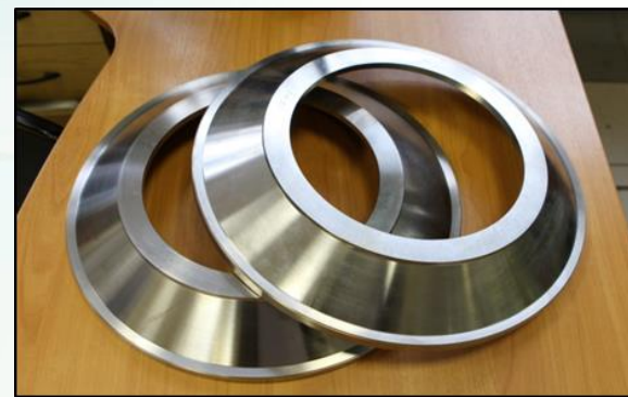
Цапфа 3 ст. КВД из сплава ВТ41
