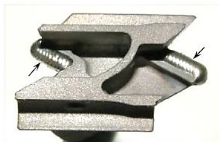
Внешний вид лопатки после наплавки (места наплавки указаны стрелками)
