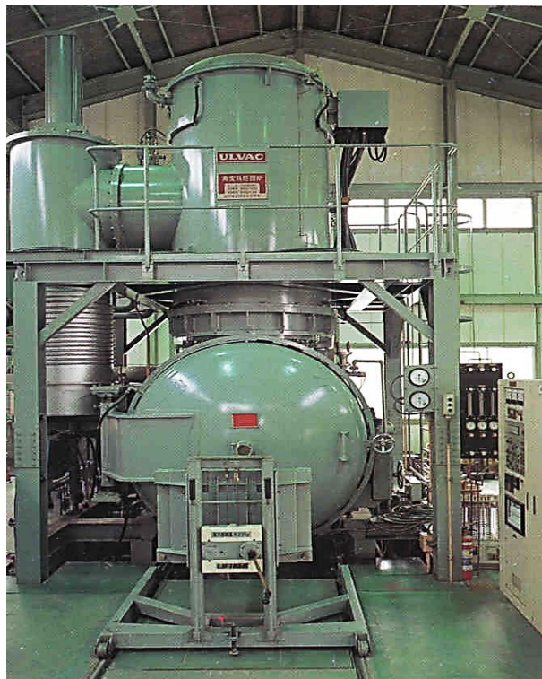
Печь ULVAC с рабочим пространством \varnothing 900 \times 900 мм, точность по температуре \pm 5^\circ\text{C}
