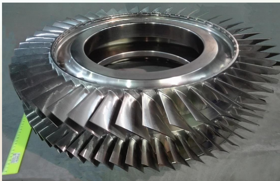
Сварной узел рабочего колеса 1 ст. и рабочего колеса 2 ст. КВД из сплава ВТ41 после окончательного фрезерования лопаток
