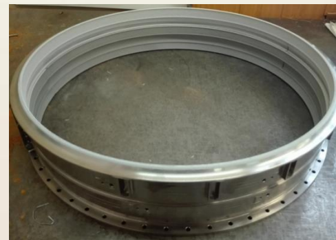
Корпус внутренний 4-6 ст. КВД из ВТИ-4
