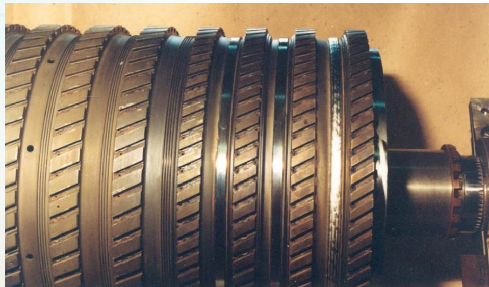
С оплавленным кольцом между дисками 8-ой и 9-ой ступеней
