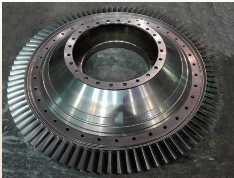
Сварной узел рабочего колеса 3-й ступени и цапфы 3-й ступени КВД из сплава ВТ41 после окончательного фрезерования лопаток
