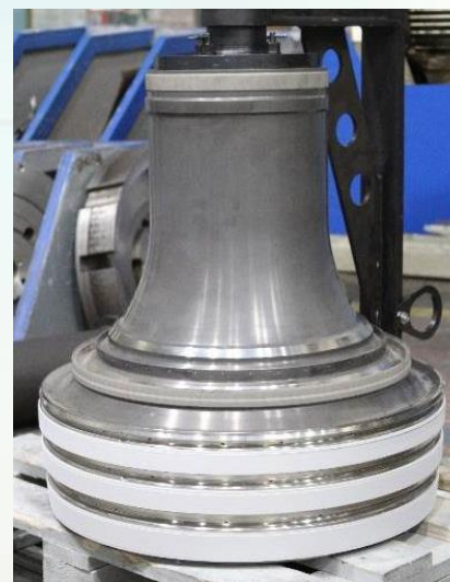
Секция ротора 4-6 ст. КВД из ВЖ172-ИШ
