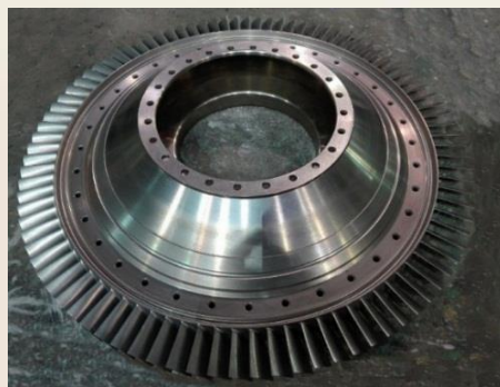
Секция ротора 3 ст. КВД из ВТ41
