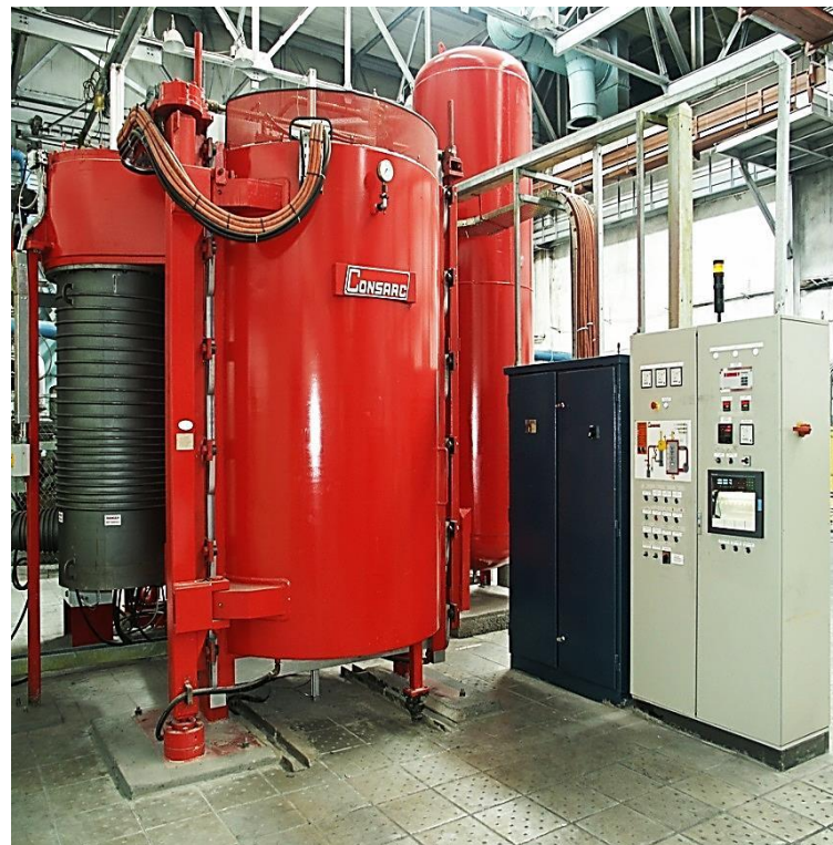
Печь CONSARC с рабочим пространством \varnothing 1210 \times 1300 мм, точность по температуре \pm 5^\circ\text{C}
