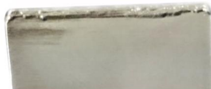
Закрепленная в оснастке лопатка КВД перед наплавкой
