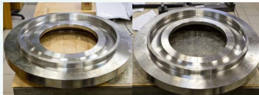
Колесо рабочее 2 ст. КВД из сплава ВТ41
