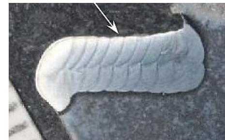
Макроструктура по местам наплавки на лопатке (места наплавки указаны стрелками)
