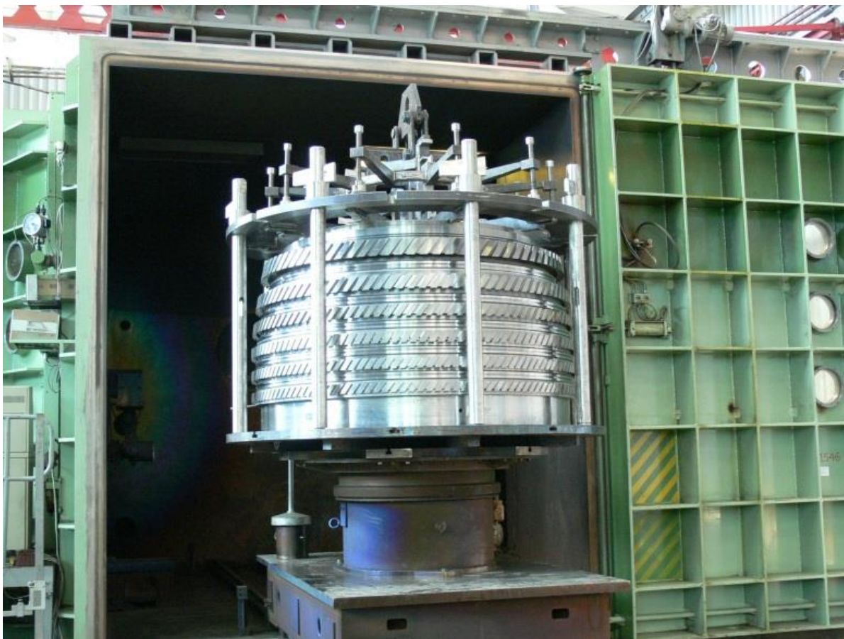
Барaban 5-10 ступени (в оснастке для сварки)
