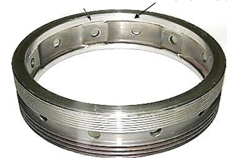
Ремонт лабиринтов наплавкой
