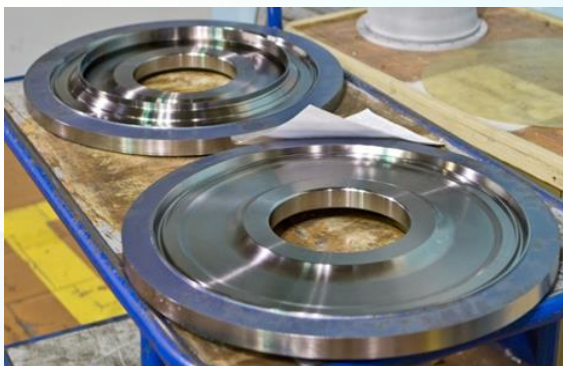
Колесо рабочее 3 ст. КВД из сплава ВТ41
